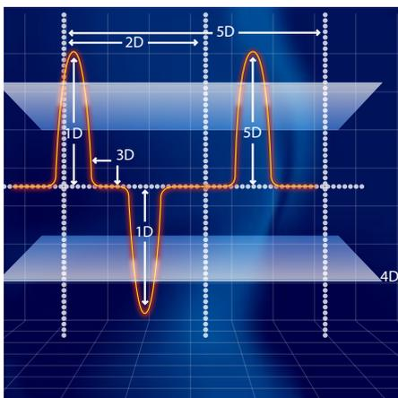
La technologie unique de traitement du signal 5D se base sur les correspondances de taille, de vitesse et de forme pour déclencher une condition d'alarme. Il en résulte une gamme de détecteurs de mouvement IRP associant une détection de sensibilité élevée à une forte résistance aux fausses alarmes. Une sensibilité et une fiabilité du système éprouvées !
