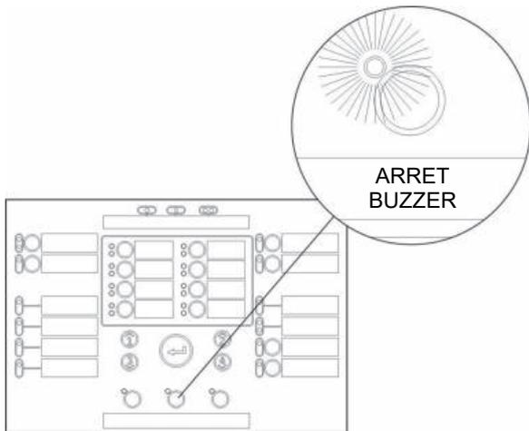
La LED Arrêt buzzer s'allume et le buzzer s'arrête. De nouveaux événements d'alarme ou de défaut vont réactiver le buzzer.
