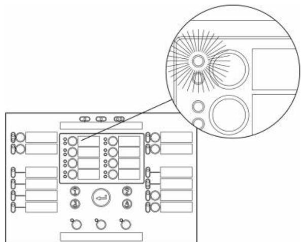
Si les LED Alarme feu et d'alarme de zone clignotent, l'alarme incendie a été activée par un détecteur. Si elles sont fixes, l'alarme incendie a été activée par un déclencheur manuel.
