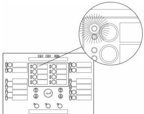
Se i LED di incendio e allarme zona lampeggiano, significa che l'allarme incendio è stato attivato da un rivelatore. Se sono accesi fissi, l'allarme antincendio è invece stato attivato da un pulsante.
