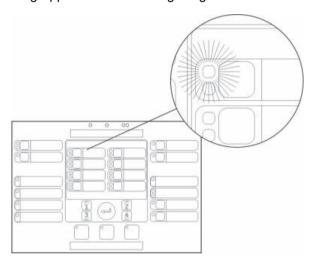
Wenn die Brand- und Meldergruppen-Alarm-LEDs blinken, wurde der Brandalarm durch einen Melder aktiviert. Falls diese konstant leuchten, wurde der Brandalarm durch einen Druckknopfmelder aktiviert.
