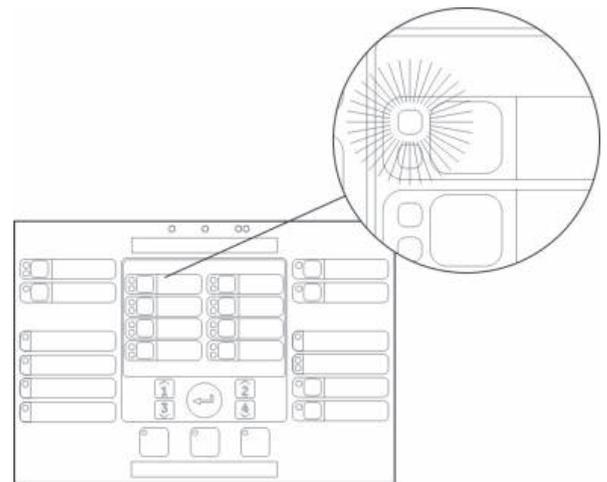
Si les LED d'alarme incendie et d'alarme de zone clignotent, l'alarme incendie a été activée par un détecteur. Si elles sont fixes, l'alarme incendie a été activée par un bouton-poussoir d'alerte.
