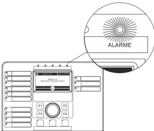
Se o besouro soar e o LED de Falha estiver fixo, existe uma falha.
