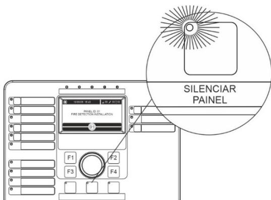
O LED de Silenciar Painel acende e o besouro é silenciado. Novos eventos de alarme ou de falha voltarão a ativar o besouro.
