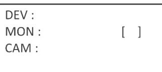
4. Per selezionare il dispositivo, immettere il numero ID del registratore o del decoder da controllare, quindi premere il pulsante **DEV** (DISPOSITIVO). Il numero appare in corrispondenza di DEV.
