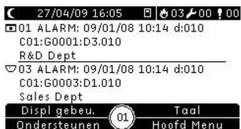
Afbeelding 4: Brandalarmaanduiding op de LCD van de centrale
