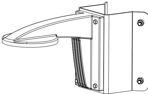
2. Yüzeyi işaretleyin ve dört montaj deliği açın. Köşe montajı adaptörünü bir binanın köşesine B ankrajını kullanarak takın. Köşe adaptörünü montaj yüzeyine civatalamadan önce kabloları duvar montajının içinden geçirin.
