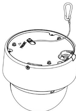
7. Güvenlik halatını, kapak tabanının içindeki metal şeride gösterildiği gibi tutturun.
