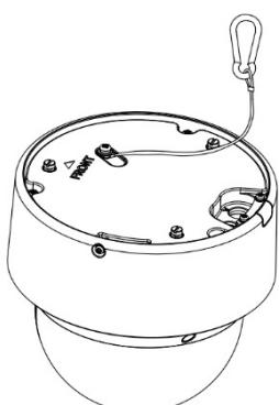
7. Güvenlik halatını, kapak tabanı duvar montajının içindeki metal şeride tutturun.
