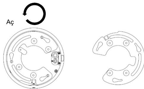
3. Metal PTZ adaptör plakasını kapak tabanına yerleştirin. Üstünde FRONT (ÖN) yazan ok, duvar montajının tabanından uzağa çevrilmelidir. A vidasını kullanarak adaptör plakasını kapak tabanına sabitleyin. A vidasını tamamen sıkın. Aksi halde dome üç emniyetin üzerinde gerektiği gibi kaymayacaktır ve vidanın başı dönüşü engelleyecektir.
