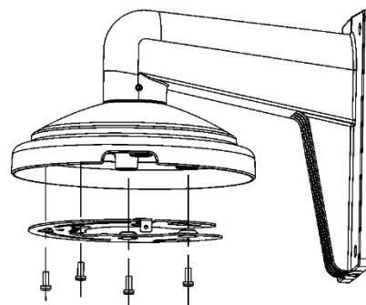
4. Duvar montajının tabanını, genişletme ankrajları için açılacak delikleri işaretlemek ve aynı zamanda montajı takmadan önce kablo demetine erişim sağlamak için kullanın.
