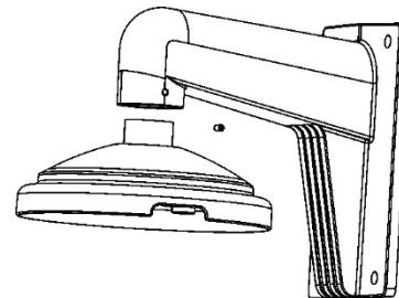
2. PTZ ile verilen Torx anahtarını kullanarak PTZ'nin tabanındaki Torx vidasını gevşetin. PTZ kameranın tabanındaki üç vidayı/emniyeti hafifçe gevşetin ve metal adaptör plakasını PTZ kameradan ayırmak için saatin tersi yönünde döndürün.
