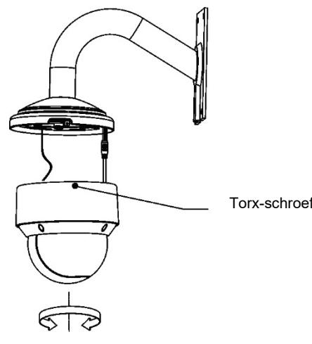
10. Draai de Torx-schroef aan de onderkant van de PTZ vast om deze op zijn plaats te vergrendelen.
