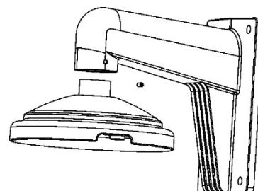
2. Gebruik de Torx-inbussleutel die bij de PTZ wordt geleverd, draai de Torx-schroef aan de onderkant van de PTZ los. Maak de drie schroeven/standoff-bevestigingsmaterialen aan de onderkant van de PTZ-camera een beetje los en draai de metalen adapterplaat tegen de klok in om hem van de PTZ-camera los te maken.
