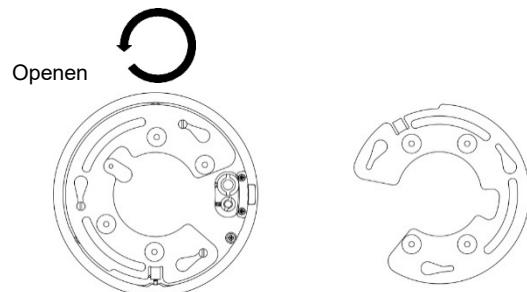
3. Plaats de metalen PTZ-adapterplaat op de sokkel. De pijl met FRONT moet weg van de basis van de wandmontage wijzen. Bevestig de adapterplaat met behulp van schroef A aan de sokkel. Draai schroef A volledig vast, anders zal de dome niet goed op zijn plaats schuiven over de drie standoff-bevestigingsmaterialen en de schroefkop zal de rotatie blokkeren.
