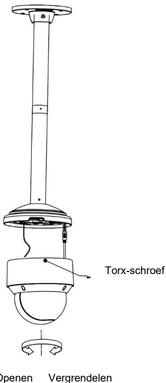
9. Draai de Torx-schroef aan de onderkant van de PTZ vast om deze op zijn plaats te vergrendelen.
