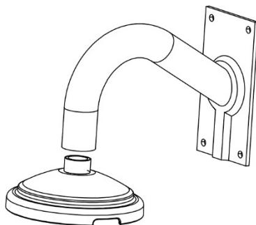
2. Gebruik de Torx-inbussleutel die bij de PTZ wordt geleverd, draai de Torx-schroef aan de onderkant van de PTZ los. Maak de drie schroeven/standoff-bevestigingsmaterialen aan de onderkant van de PTZ-camera een beetje los en draai de metalen adapterplaat tegen de klok in om hem van de PTZ-camera los te maken.
