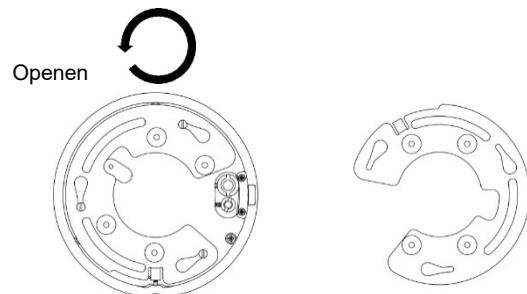
3. Plaats de metalen PTZ-adapterplaat op de sokkel. De pijl met FRONT wijst weg van de basis van de wandmontage. Bevestig de adapterplaat met behulp van schroef A aan de sokkel. Draai schroef A volledig vast. Anders zal de dome niet goed op zijn plaats schuiven over de drie standoff-bevestigingsmaterialen, en de schroefkop zal de rotatie blokkeren.
