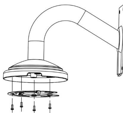
4. Gebruik de wandmontagebasis om de gaten voor de expansiepluggen te markeren en om ook toegang tot de kabelboom te bieden voordat u met de montage installeert.
