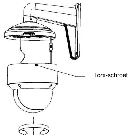
10. Draai de Torx-schroef aan de onderkant van de PTZ vast om deze op zijn plaats te vergrendelen.
