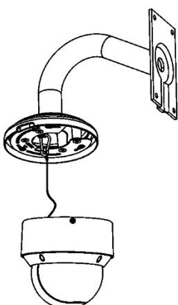
8. Leid de PTZ-kabelboom door de sokkel. Als u niet alle functies/kabels gebruikt, kunt u ze achter de PTZ-adapterplaat steken om ze uit de weg te houden, zodat ze niet interfereren wanneer u de PTZ op de sokkel installeert.
