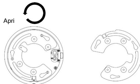
3. Posizionare la piastra di adattamento PTZ in metallo sulla base. La freccia che indica FRONT deve essere rivolta nella direzione opposta rispetto alla base del supporto di montaggio a parete. Usando la vite A, fissare la piastra di adattamento alla base. Stringere completamente la vite A. In caso contrario, la dome non scorrerà correttamente in posizione sui tre separatori e la testa della vite bloccherà la rotazione.
