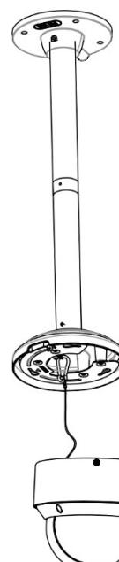
7. Far passare il cavo PTZ attraverso la base. Se non si utilizzano tutte le caratteristiche / i cavi, è possibile riporli dietro la piastra di adattamento PTZ per tenerli lontani, in modo che non interferiscano quando si installa la PTZ sulla base.
