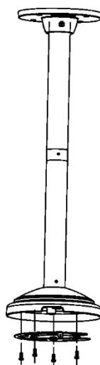
4. Far passare i cavi di interconnessione della telecamera nel supporto di montaggio a pendente. Fissare il supporto al soffitto con gli ancoraggi di espansione inclusi con il supporto di montaggio a pendente.
