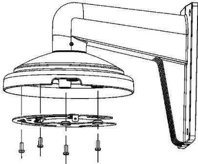
4. Utilizzare la base del supporto di montaggio a parete per contrassegnare i fori per i tasselli di espansione e per fornire anche l'accesso per il cablaggio prima dell'installazione con il supporto.
