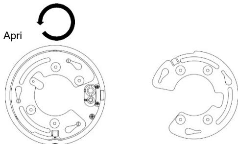
3. Posizionare la piastra di adattamento PTZ in metallo sulla base. La freccia che indica FRONT deve essere rivolta nella direzione opposta rispetto alla base della base. Usando la vite A, fissare la piastra di adattamento alla base. Stringere completamente la vite A. In caso contrario, la dome non scorrerà correttamente in posizione sui tre separatori e la testa della vite bloccherà la rotazione.
