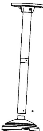
2. Usando la chiave Torx in dotazione con la PTZ, allentare la vite Torx alla base della PTZ. Allentare leggermente le tre viti/separatori sulla base della telecamera PTZ e ruotare la piastra di adattamento in metallo in senso antiorario per separarla dalla telecamera PTZ.
