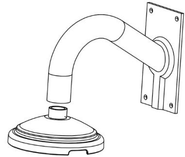
2. À l'aide de la clé Torx fournie, desserrez la vis Torx située sur la base de la caméra. Desserrez ensuite légèrement les trois autres vis se trouvant au même endroit, puis faites pivoter la plaque adaptatrice métallique dans le sens inverse des aiguilles d'une montre pour la dissocier de la caméra.
