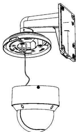
8. Acheminez le faisceau de câbles à travers la base. Si vous n'utilisez pas tous ces câbles, vous pouvez les placer derrière la plaque adaptatrice afin qu'ils ne constituent pas une gêne lors de l'installation de la caméra sur la base.
