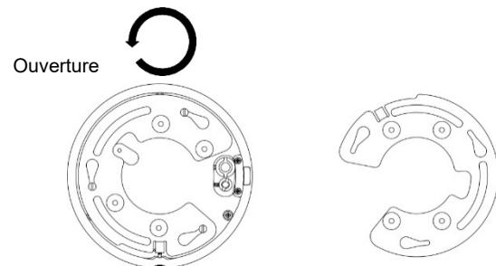
3. Placez la plaque adaptatrice métallique de la caméra sur la base. La flèche accompagnée de l'indication FRONT doit être orientée vers l'extérieur. Ensuite, à l'aide de vis A, fixez la plaque adaptatrice à la base. Serrez-les complètement. Dans le cas contraire, la caméra ne sera pas correctement mise en place au niveau des trois entretoises, et la tête de cette même vis empêchera toute rotation.
