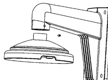
2. À l'aide de la clé Torx fournie, desserrez la vis Torx située sur la base de la caméra. Desserrez ensuite légèrement les trois autres vis se trouvant au même endroit, puis faites pivoter la plaque adaptatrice métallique dans le sens inverse des aiguilles d'une montre pour la dissocier de la caméra.
