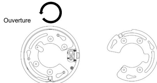
3. Placez la plaque adaptatrice métallique de la caméra sur la base. La flèche accompagnée de l'indication FRONT doit être orientée vers l'extérieur. Ensuite, à l'aide de vis A, fixez la plaque adaptatrice à la base. Serrez complètement la vis A. Dans le cas contraire, la caméra ne sera pas correctement mise en place au niveau des trois entretoises, et la tête de cette même vis empêchera toute rotation.
