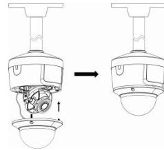
**Pour monter une caméra dôme sur un support mural TVD-CBW à l'aide d'une base TVD-CB7 :**
