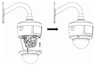
**Para montar una cámara domo en un montaje en suspensión TVD-PPB con una base de tapa TVD-CB7:**
