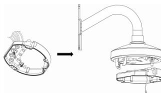
7. Coloque el cordón de seguridad y conecte los cables de la cámara a la base de la cámara domo. Siga las instrucciones de la guía de instalación de la cámara domo para cumplir con la clasificación IP67.
