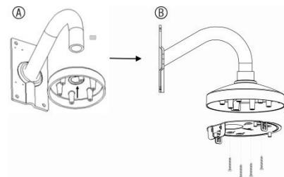
6. Pase los cables de la cámara a través de la caja de conexiones y alinee las marcas "FRONT" (parte delantera) ubicadas en el interior de la caja de conexiones con la marca de la placa adaptadora. A continuación, fije la caja de conexiones a la placa adaptadora apretando los tres tornillos Torx.
