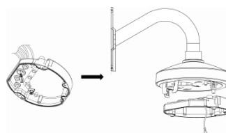
7. Befestigen Sie die Sicherungsschnur und verbinden Sie die Kamerakabel mit der Basis der Dome-Kamera. Befolgen Sie die Anweisungen in der Installationsanleitung der Dome-Kamera, um die Schutzart IP67 zu gewährleisten.
