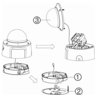
6. Schrauben Sie die Glockenbasis auf die Schwanenhals-Halterung und befestigen Sie sie mit der Sicherungsschraube. Führen Sie die Kamerakabel durch die Adapterplatte.
