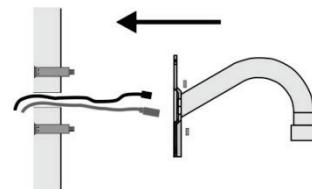
2. Heben Sie das Kameragehäuse an, um die Verteilerdose und die Adapterplatte voneinander zu trennen.
