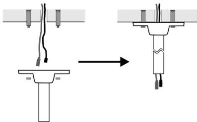
3. Heben Sie das Kameragehäuse an, um die Verteilerdose und die Adapterplatte voneinander zu trennen.
