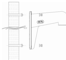
2. Heben Sie das Kameragehäuse an, um die Verteilerdose und die Adapterplatte voneinander zu trennen.
