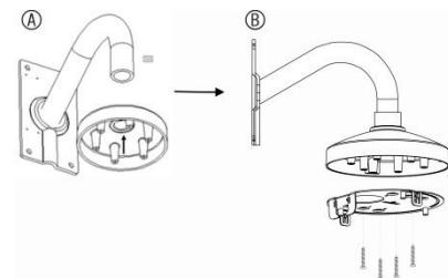
6. Führen Sie die Kamerakabel durch die Verteilerdose, richten Sie die "FRONT"-Markierungen auf der Innenseite der Verteilerdose an der Markierung auf der Adapterplatte aus und befestigen Sie die Verteilerdose an der Adapterplatte, indem Sie die drei Torx-Schrauben festziehen.
