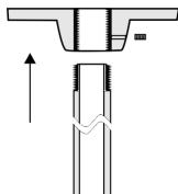
2. Führen Sie die Kamerakabel durch die Hängehalterung. Befestigen Sie die Halterung mit den im Lieferumfang enthaltenen Spreizdübeln an der Decke.
