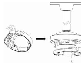
9. Befestigen Sie die Sicherheitsschnur und verbinden Sie die Kamerakabel mit der Basis der Dome-Kamera. Befolgen Sie die Anweisungen in der Installationsanleitung der Dome-Kamera, um die Schutzart IP67 zu gewährleisten.
