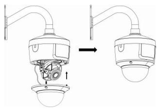
**So montieren Sie eine Dome-Kamera mit einer TVD-CB7-Glockenbasis an einer TVD-PPB-Hängehalterung:**
