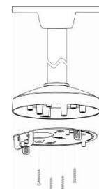
8. Führen Sie die Kamerakabel durch die Verteilerdose, richten Sie die "FRONT"-Markierungen auf der Innenseite der Verteilerdose an der Markierung auf der Adapterplatte aus und befestigen Sie die Verteilerdose an der Adapterplatte, indem Sie die drei Torx-Schrauben festziehen.
