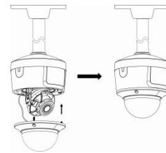
**So montieren Sie eine Dome-Kamera mit einer TVD-CB7-Glockenbasis an einer TVD-CBW-Wandhalterung:**
