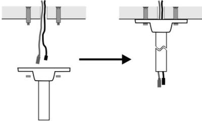
3. Kapak tabanını askı montajına vidalayın ve kilitleme vidasıyla sıkın. Kameranın montaj plakasını, adaptör plakasının montaj vidalarını kullanarak kapak tabanına takın.
