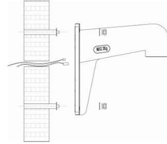
2. Kapak tabanını duvar montajına vidalayın ve aşağıda gösterildiği şekilde (A) kilitleme vidasıyla sıkın. Kameranın adaptör plakasını kapak tabanına (B) A vidasını kullanarak takın, kamera kablolarını adaptör plakasından geçirin.
