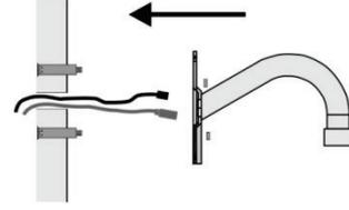
2. Kapak tabanını kuğu boynu montajına vidalayın ve aşağıda gösterildiği şekilde (A) kilitleme vidası ile sıkın. Ardından kameranın adaptör plakasını (kamerayla birlikte sağlanmıştır) A vidasını kullanarak kapak tabanına (B) takın.
