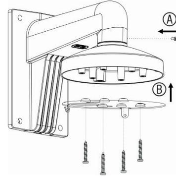
3. Güvenlik halatını (1), kapak tabanı duvar montajının içindeki metal şeride takın, ardından alt kapakta (2) yer alan iki adet Torx vidasını gevşetin ve açmak için kaldırın.
