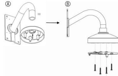
3. Güvenlik halatını (1), kapak tabanı duvar montajının içindeki metal şeride takın, ardından alt kapakta (2) yer alan iki adet Torx vidasını gevşetin ve açmak için kaldırın.
