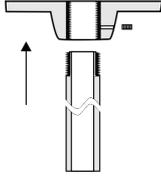
2. Kameranın ara bağlantı kablolarını askı montajından geçirin. Montajı, askı montajına dahil edilen genişletme ankrajlarını kullanarak tavana takın.
