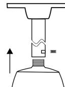
2. Verwijder de achterkap van de domecamera. Dit is niet vereist bij installatie in een sokkel.
