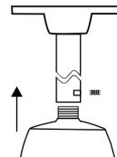
2. Retirez le boîtier arrière de la caméra dôme. Il n'est pas nécessaire lors de l'installation.
