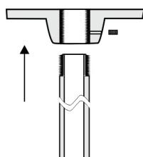
2. Acheminez les câbles de la caméra dans le support suspendu. Fixez le support au plafond à l'aide des chevilles à expansion fournies.
