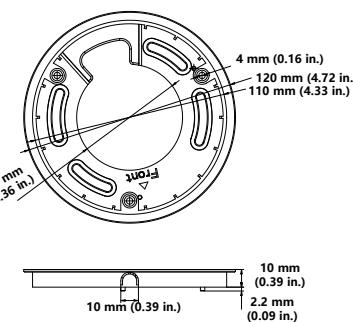
Pour monter une caméra wedge sur un support mural TVD-SNB à l'aide d'une base TVD-CB2 :
