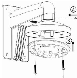
5. Fixez la base de la caméra à la plaque adaptative à l'aide des trois vis de montage M4 x 8.
