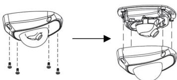
5. Branchez les câbles à la caméra. À l'aide des trois vis M4 x 8 fournies avec la caméra, fixez la base de la caméra à la plaque adaptatrice.
