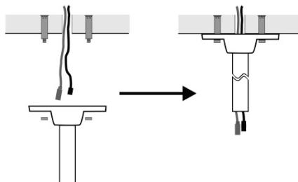
3. À l'aide des 4 vis fournies avec la caméra wedge, fixez la plaque adaptatrice à la base. Fixez la base au support suspendu et serrez à l'aide de la vis de blocage.
