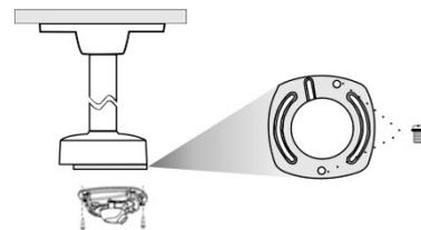
6. Vuelva a fijar la carcasa de la cámara a la cámara.
