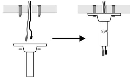
3. Con los cuatro tornillos que se incluyen con la cámara ultracompacta, coloque la placa adaptadora ultracompacta en la base de tapa. Atornille la base de tapa en el montaje en suspensión y ajústela con el tornillo de bloqueo.
