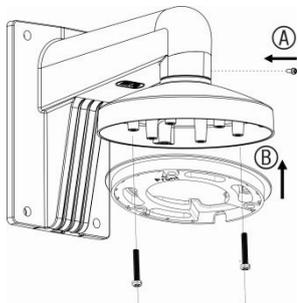
5. Monte la base de la cámara en la placa adaptadora usando los tornillos de montaje M4 x 8 (3 uds.).
