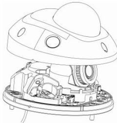
3. Pase los cables de la cámara a través de la placa adaptadora.
