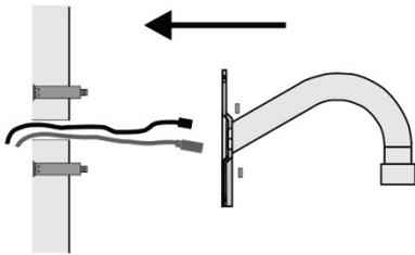
2. Usando los cuatro tornillos A, coloque la placa adaptadora ultracompacta en la base de tapa.
