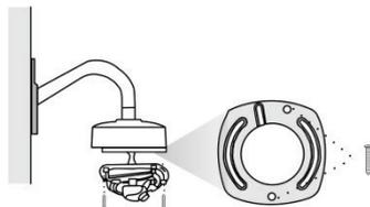
6. Vuelva a instalar el conjunto de burbuja ultracompacta en la cámara.
