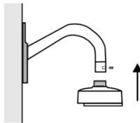
4. Afloje los tornillos del conjunto de burbuja ultracompacta utilizando la llave Torx que se suministra con la cámara, y retire la carcasa.
