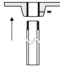
2. Pase los cables de la cámara a través del montaje en suspensión. Fije el montaje al techo con los anclajes de expansión que se incluyen con el montaje en suspensión.
