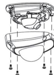
**Para montar una cámara ultracompacta en un montaje en pared TVD-CBW con una base de tapa TVD-CB2:**
