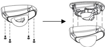
5. Conecte los cables a la cámara ultracompacta. Con dos tornillos de montaje M4 x 8 (3 uds.) que se suministran con la cámara ultracompacta, acople la base de la cámara a la placa adaptadora ultracompacta.
