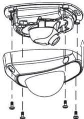
**Para montar una cámara ultracompacta en un montaje suspendido TVD-PPB con una base de tapa TVD-CB2:**
