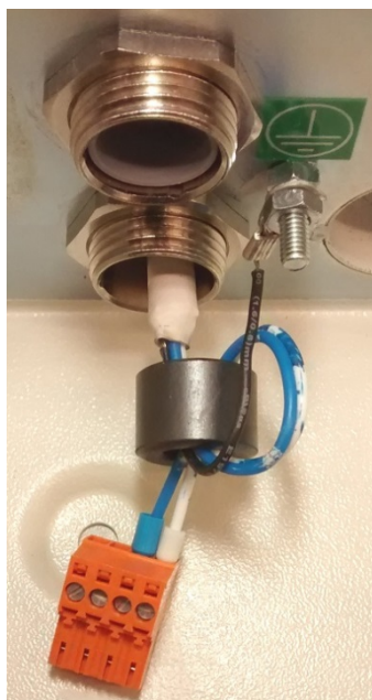
Bild 8: Vira anslutningskablar från reläer runt en dämpande ferritring
