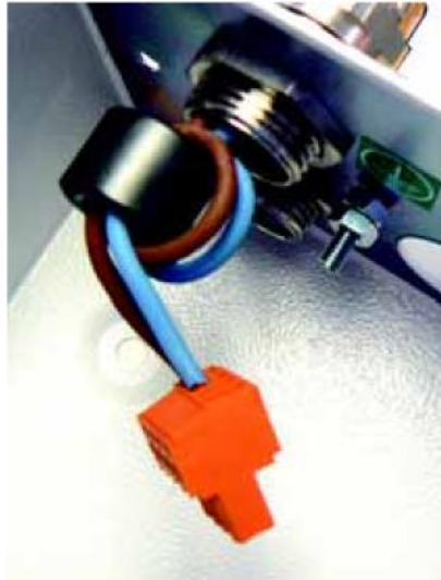
Rysunek 8: Tworzenie pętli przewodów połączeniowych przełącznika wokół ferrytu
