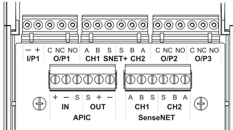
Abbildung 13: Anschlüsse der Rückwandplatine (unten)
