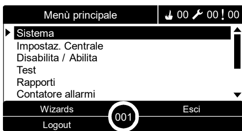
Figura 22: Menu principale del livello installatore
