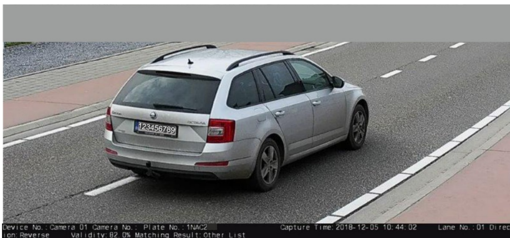
Figura 14: Exemplo de uma fotografia instantânea com o resultado de identificação de matrícula em tempo real
