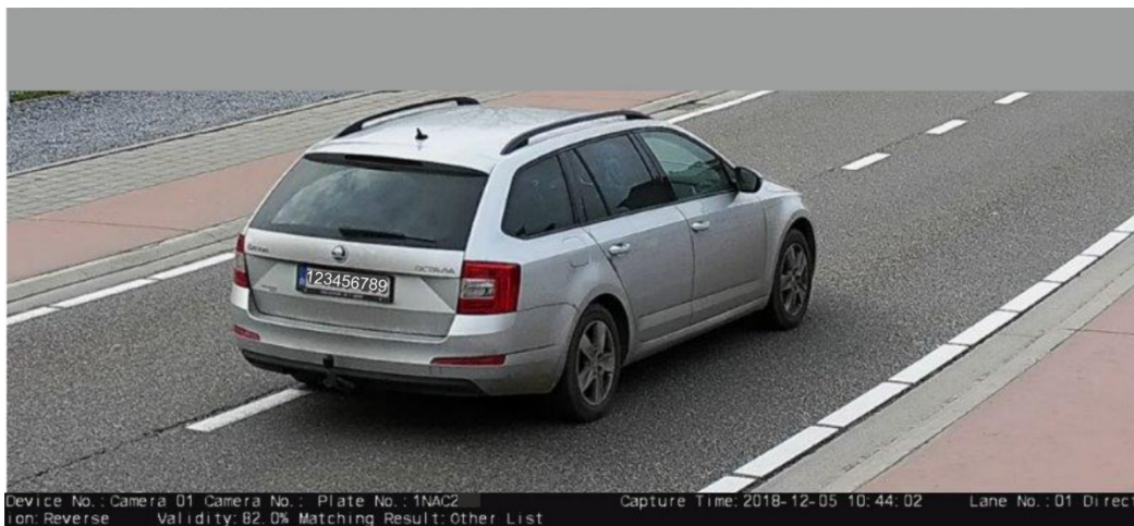
Afbeelding 14: Voorbeeld van een real-time LPR-momentopname
