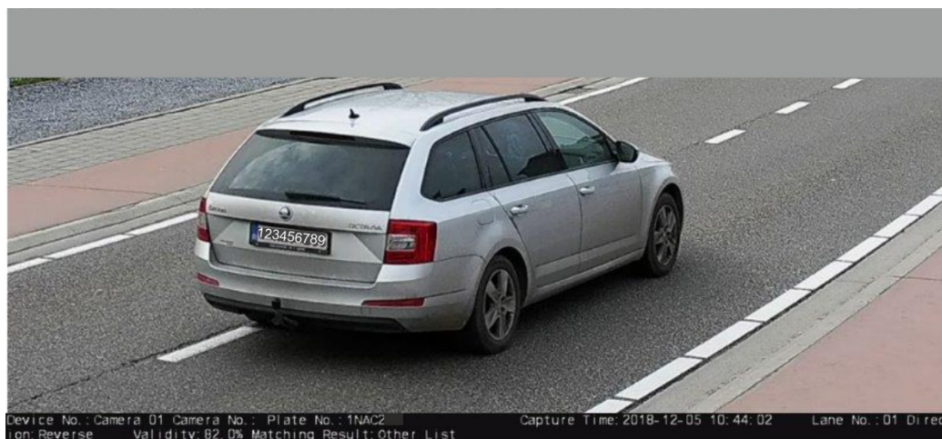
Рис. 14. Пример снимка распознавания номерных знаков в реальном времени
