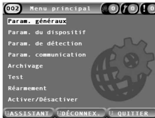
Figure 23 : Menu principal du niveau d'accès 2
