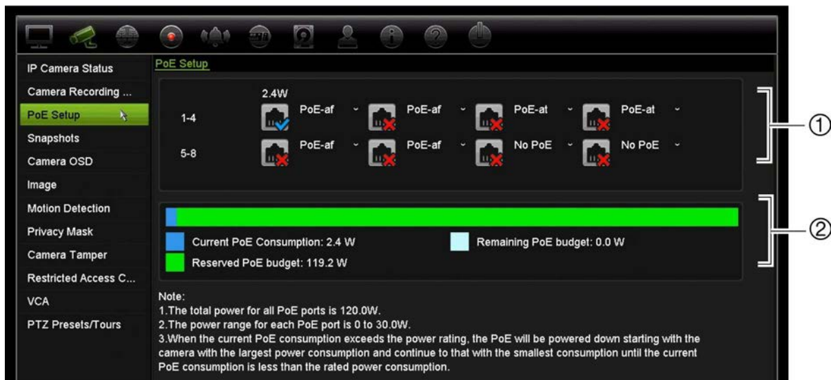
Figura 21: Informazioni su budget energetico PoE per telecamere IP
