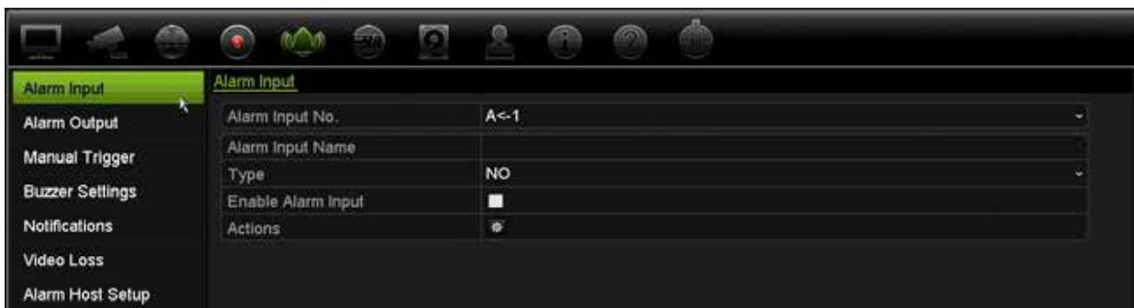
2. Selecione o número da entrada de alarme de uma câmara que corresponde ao conector no painel traseiro do gravador e introduza o nome da entrada, se necessário.
