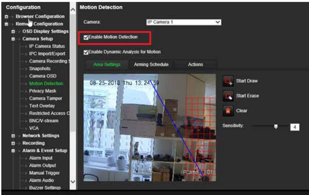
2. Selecionar Notificar host de alarme como uma ação para deteção de movimento.
