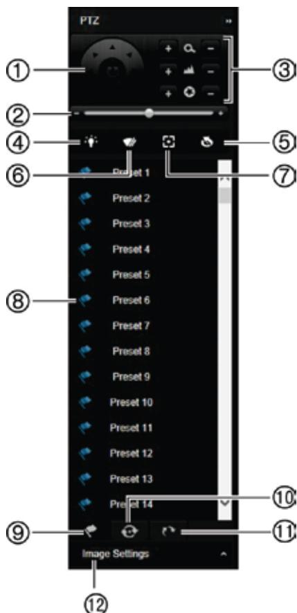
1. Botões direcionais de pad/auto-scan: controlam os movimentos e as direções do PTZ. O botão central é utilizado para iniciar a função de auto-pan pela câmara PTZ de dome.
