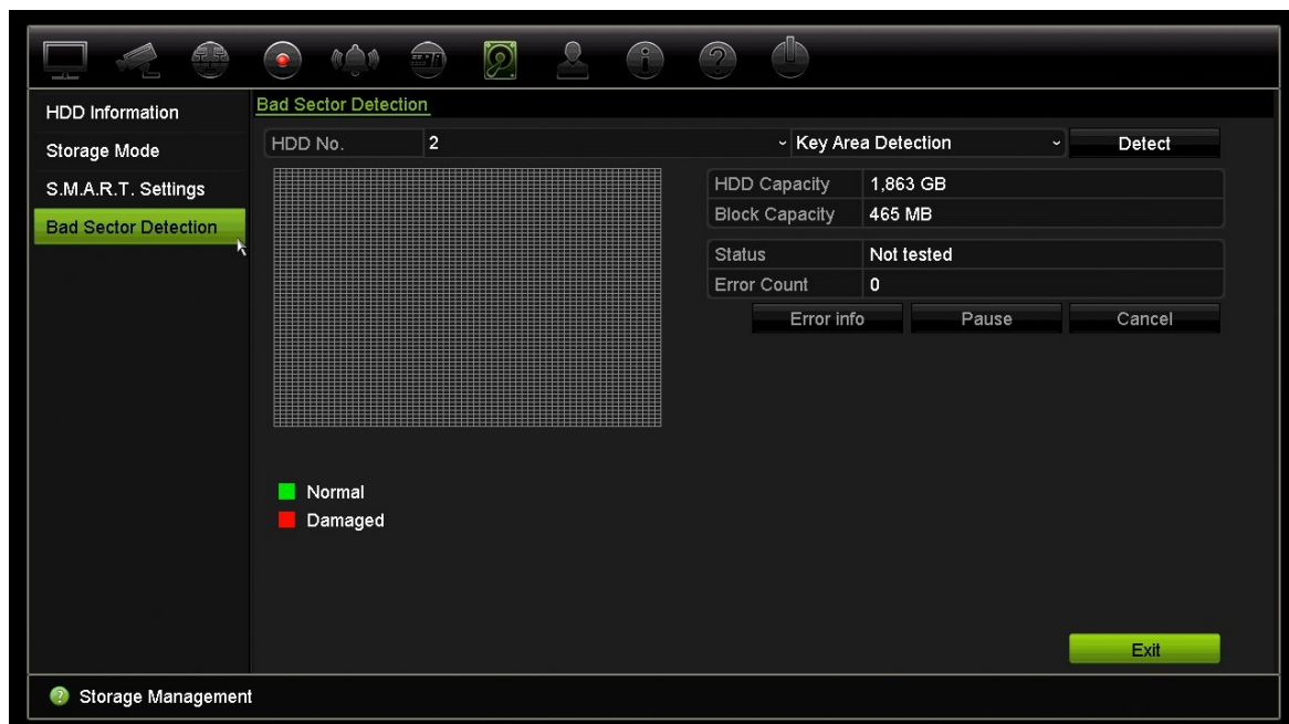
Kuva 29: Virheellisen sektorin tunnistuksen ikkuna
