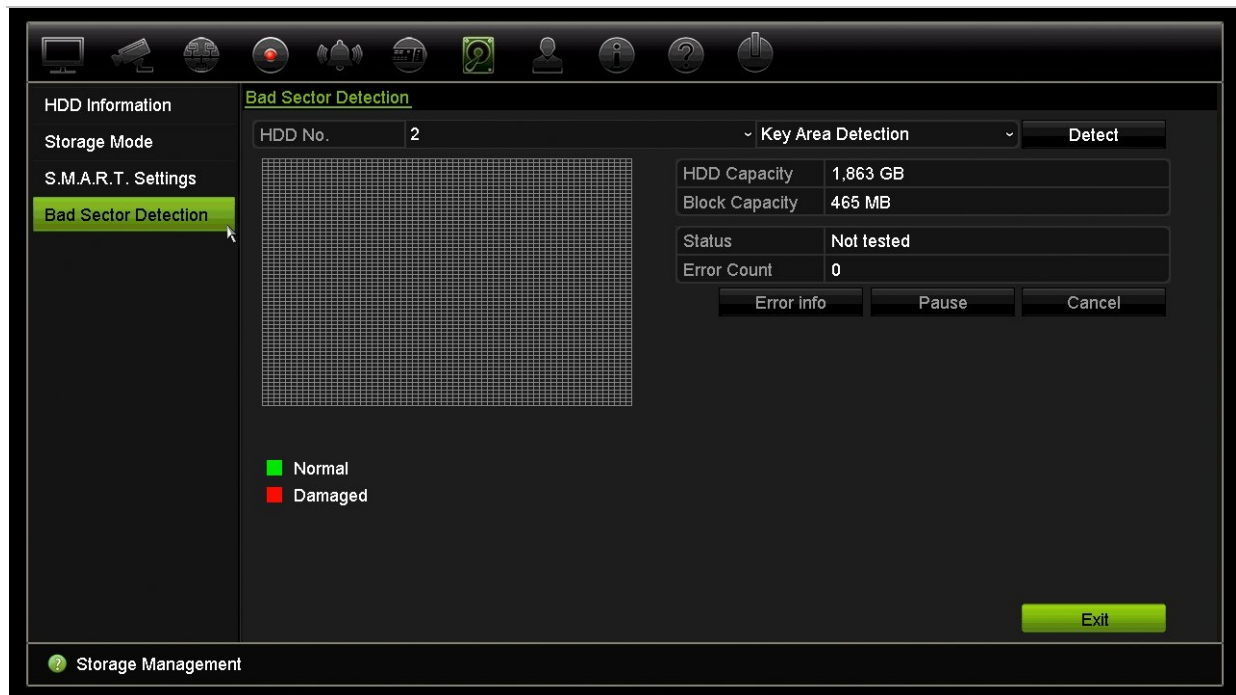
Abbildung 28: Fenster mit Erkennung beschädigter Sektoren
