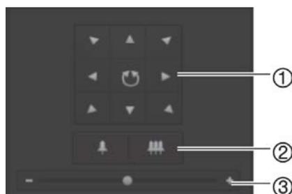
1. **Richtungsschaltflächen:** Steuert die Bewegungen und Richtungen der PTZ-Kamera. Mit der mittleren Taste wird das automatische Schwenken durch die PTZ-Dome-Kamera gestartet.
