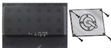
A base do monitor é fixada aqui
