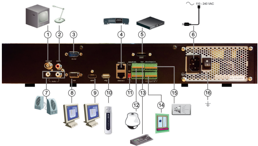
Figur 1: Tilslutninger på enhedens bagpade TVN 21(P)
