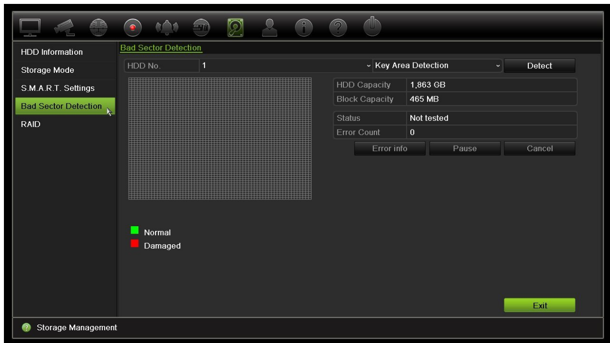
Kuva 34: Virheellisen sektorin tunnistuksen ikkuna
