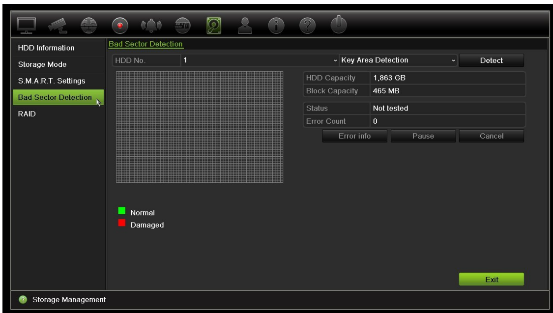
Figura 35: Janela de deteção de sector danificado
