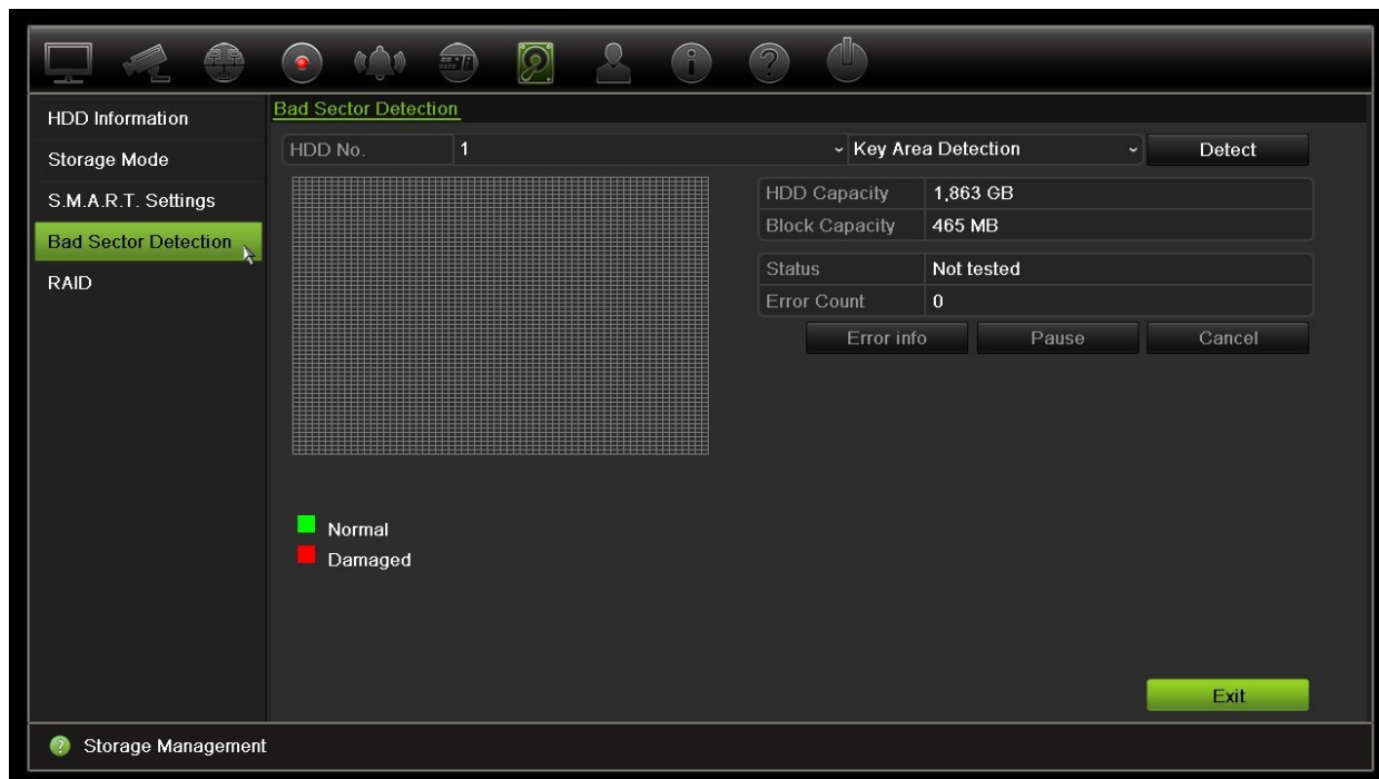
Figure 35 : Fenêtre de détection de secteurs endommagés
