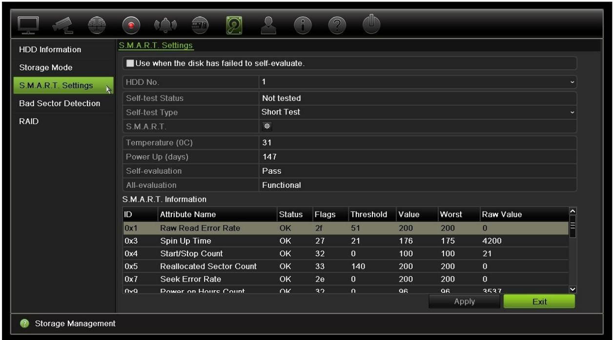
3. Si desea seguir utilizando una unidad de HDD aunque la prueba de S.M.A.R.T. falle, active la casilla **Use when the disk has failed to self-evaluate** (Utilizar cuando el HDD ha fallado en la autoevaluación). Haga clic en **Aplicar** para guardar la configuración.
