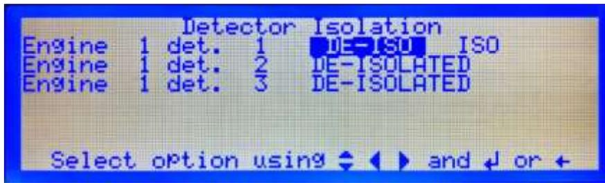
Figure 119 Isolate Detector
